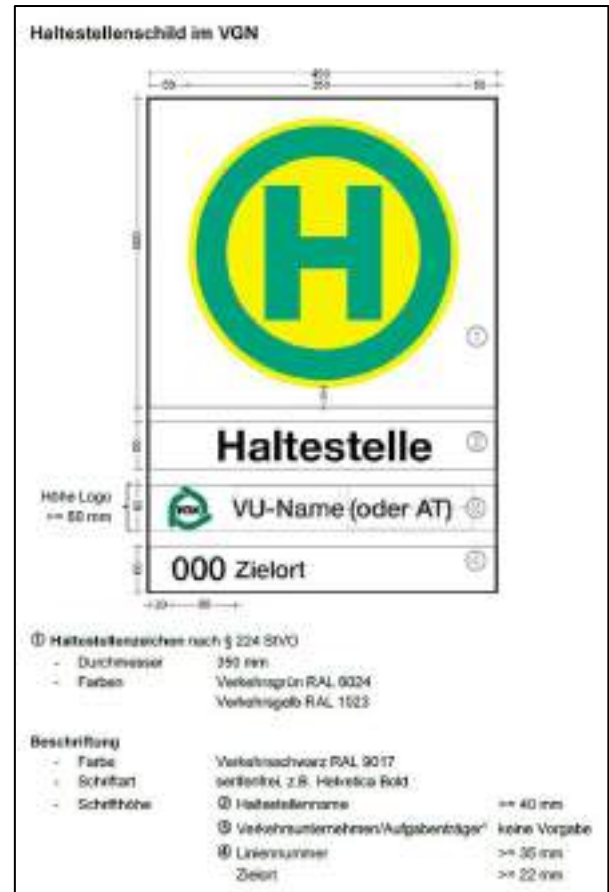
Abb. 39: Aufbau eines Haltestellenschildes nach VGN-Standard
