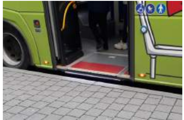
Abb. 22: Durch nahes Anfahren und Kneeling-Funktion des Busses kann die Reststufe und Spaltbreite zwischen Fahrzeugboden und Bussteigkante deutlich reduziert werden – im Idealfall auf 5 x 5 cm.
